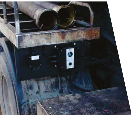
Earth-Rite II MGV El sistema de puesta a tierra de estática puede montarse en camiones de vacío y camiones cisterna.
