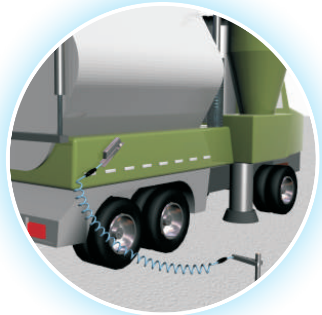
Potentialausgleich eines Saugfahrzeugs an einem Erdungsstab
